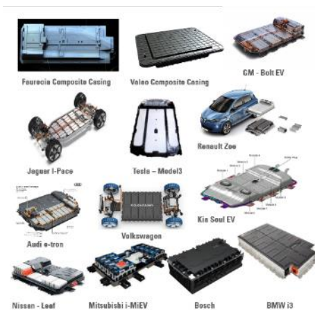
Abbildung 1: Die Mehrheit der existierenden Batteriegehäuse für elektrische Fahrzeuge wird aus Stahl und Aluminium gefertigt.
