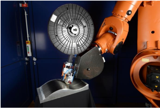
Abb. 2: Applikator "PrePro 3D" zur modularen Integration in bestehende Produktionssysteme. Copyright: Fraunhofer IPT.
