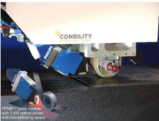
Abb. 3: VCSEL-Tapelege- und Tape-Wickel-Applikator. Copyright: Conbility GmbH.
