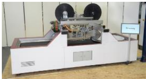
Abb. 1: Maschinensystem "PrePro 2D" für das Tapelegen zu maßgeschneiderten Organoblechen und Laminaten mit In-situ-Konsolidierung. Copyright: Fraunhofer IPT.
