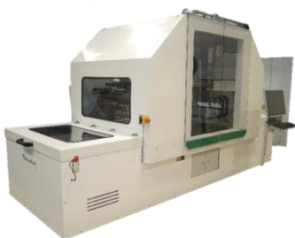
Abb. 1: Maschinensystem "PrePro 2D" für das Tapelegen zu maßgeschneiderten Organoblechen und Laminaten mit In-situ-Konsolidierung. Copyright: Fraunhofer IPT.
